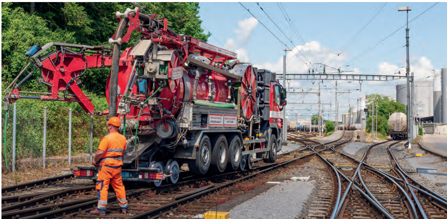
Séparation en eau et matières solides par ajout d'agent flocculant et filtration multiple.
